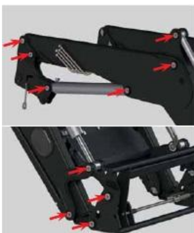
Все места смазки легко доступны снаружи.
