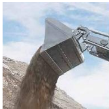
Экономия времени с помощью системы быстрой выгрузки ковша.
