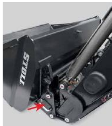
... фиксация осуществляется автоматически при зачерпывании рабочего органа.
