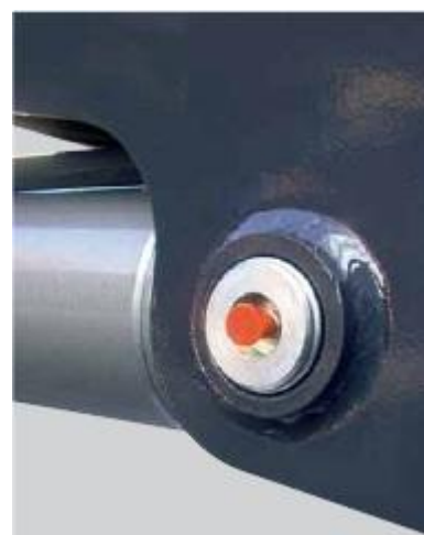
Каждая втулка смазывается в отдельности.
