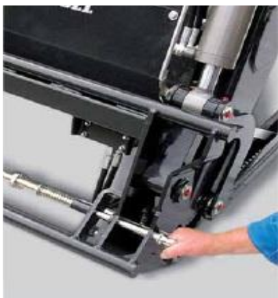
Процесс фиксации навесного оборудования безопасно осуществляется сбоку.
